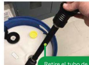
Retire el tubo de inmersión y la válvula con el puerto abierto para ajustar el pH.
